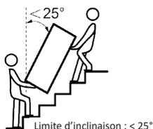
Figure 3.2-1 Schéma de transport de l'appareil
