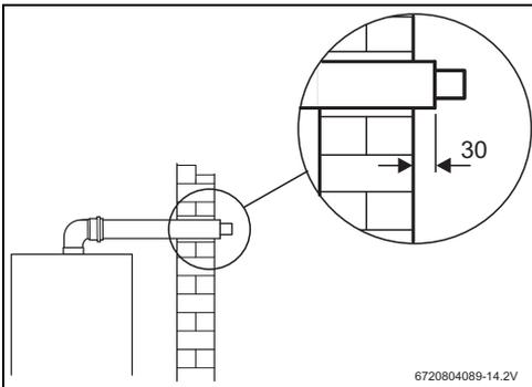
Fig. 20 Dimensions (en mm)
