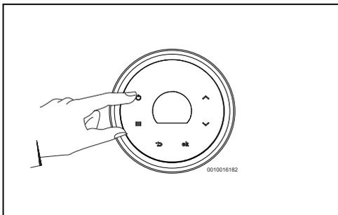
Fig. 4 Mise en marche / arrêt de l'appareil
