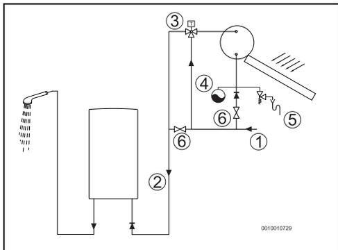
Fig. 16 Installation solaire
