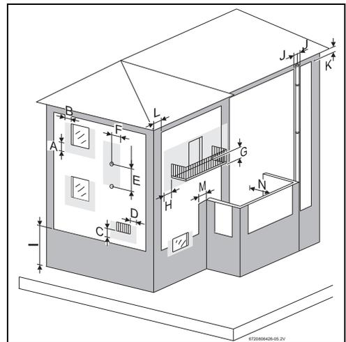
Fig. 18 Distances minimales par rapport aux conduites d'évacuation des fumées
