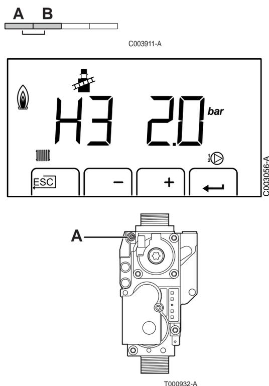
1. Régler la chaudière sur le mode grande vitesse. Appuyer simultanément sur les touches **A** et **B**.
