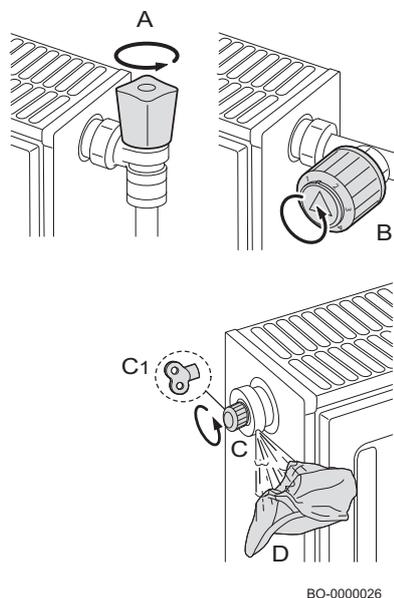
1. Ouvrir les robinets A et B de tous les radiateurs raccordés au système de chauffage.
