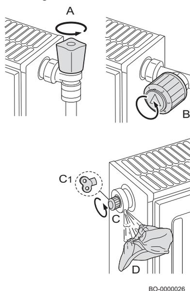
1. Ouvrir les robinets A et B de tous les radiateurs raccordés au système de chauffage.
