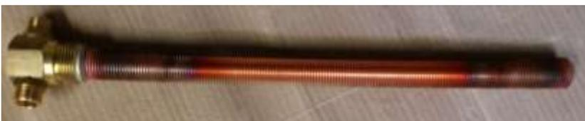
Le bouchon femelle à empreinte carrée peut être dévissé à l'aide d'une clé à douille (cliquet) de taille 1/2", ou d'un fer carré de 18mm x 18mm x 70 mm inséré dedans sur lequel on agrippe une clé à griffe.
