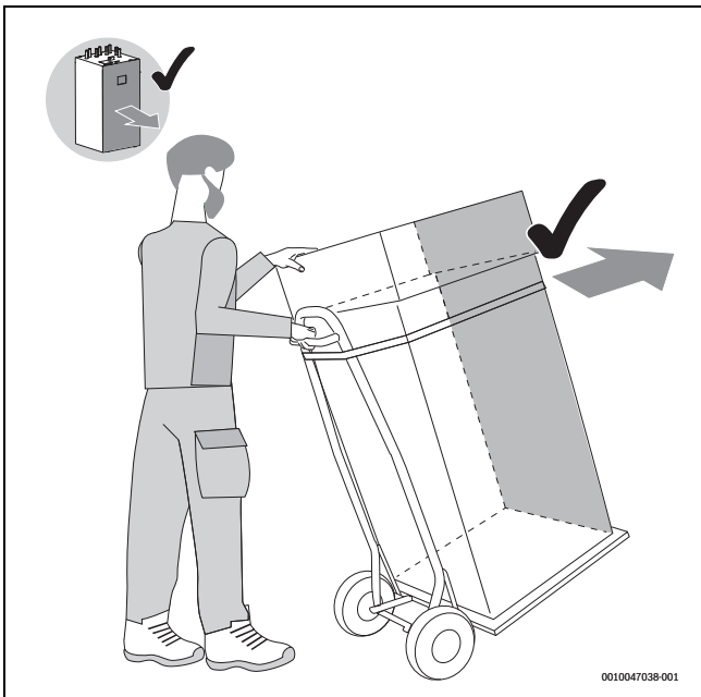
Fig. 9 Transport de l'unité intérieure avec un diable
