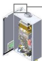
Poser la façade du chauffe-bain sur l'embout à gauche spécialement développé pour vous faciliter la maintenance : vous pouvez facilement interagir avec l'interface tout en effectuant vos réglages à l'intérieur de l'appareil
